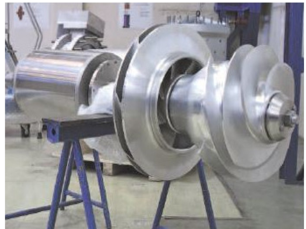
Fig. 1 Impeller and inducer of LNG cargo pump
